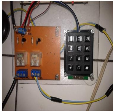
**Gambar 5.** Sirkuit relay untuk peubah tegangan antara mikrokontroler dan instrumen uji-coba
